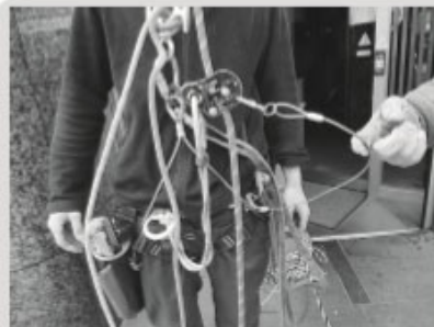
墜落阻止器具は、コング社バックアップ。屋上で取り付けるための落下防止コードも接続されており、○。
