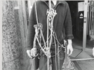
2本のロープを束ねてメインロープとし、接続器具(下降器)はジェットマン。左側のロープがライフライン。
